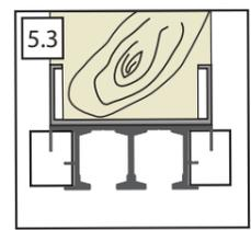
Viga em madeira para reduzir vibrações no teto falso (não fornecido)
