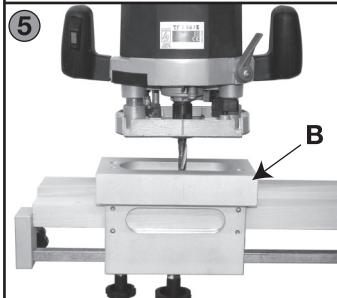
\*Fissare la dima "A" con le apposite viti. Procedere con il preforo (H max= 23 mm, 12<Ø<14 mm).
