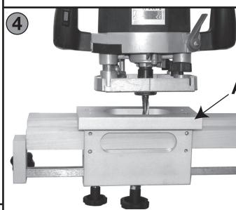
\*Sostituire la dima "A" con la dima "B". Fissare con le apposite viti. Procedere con la 2<sup>a</sup> lavorazione.
