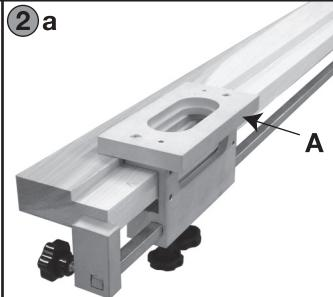
in Bedienungsanleitung und fest an das Türblatt und an der Stange anbringen in dem man die dafür eigens bestimmten Handgriffe dreht.
